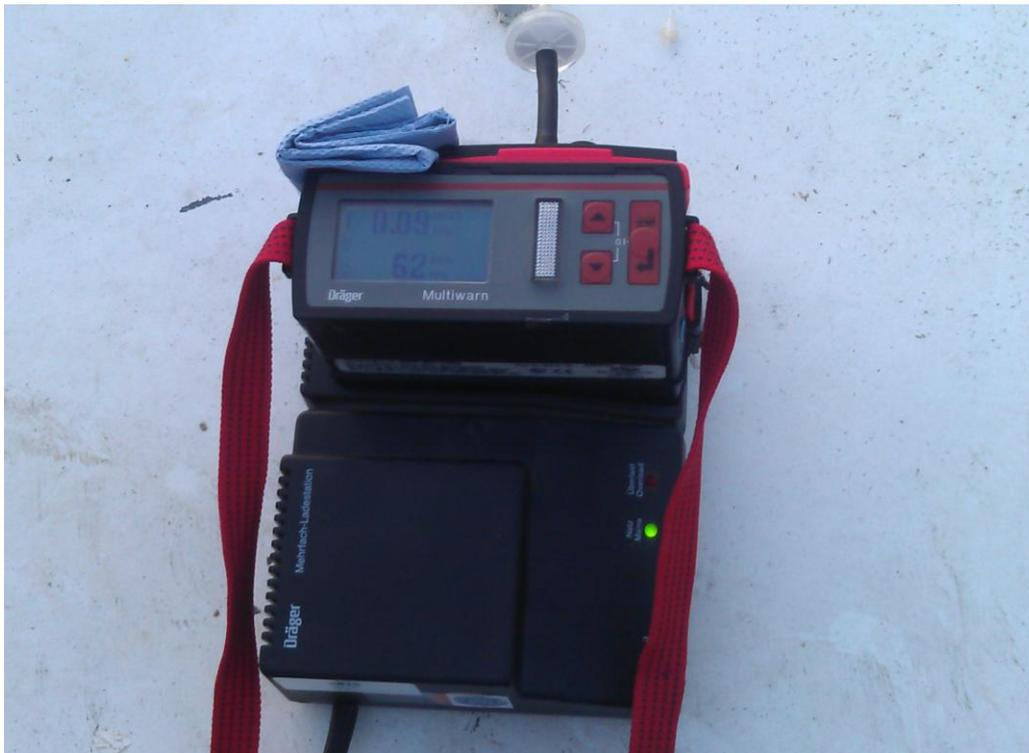
**Abbildung 3:** Messgerät Dräger Multiwarn II
